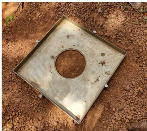
Figura 1. Exemplo de fixação da bandeja com utilização de pregos com cabeça
