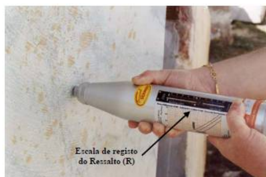
Figura 1 – Aspecto do esclerômetro ou martelo de Schmidt durante a realização de um ensaio (fonte: GUERREIRO, 2000).
